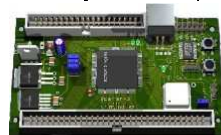
Spartan-3 XC3S200 razvojni modul (Lab)
