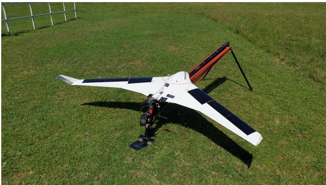
Slika 4.2: Izgled s sončnimi moduli opremljenega letalnika Bramor.
