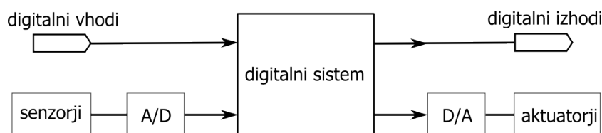
Slika 1.8: Vhodi in izhodi digitalnega sistema.
