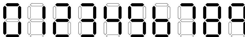
Slika 4.10: Prikaz desetiških števk na 7-segmentnem prikazovalniku.
