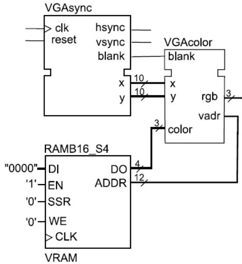
V vezju **VGASync** iz prejšnje vaje bo potrebno vnesti nekaj popravkov. Vhod vezja spremenite iz clk25 na clk in odstranite DCM za množenje ure, ker bo množenje narejeno v komponenti VGATest. Odstranite tudi izhod rgb in dodajte na izhod signala x in y.
