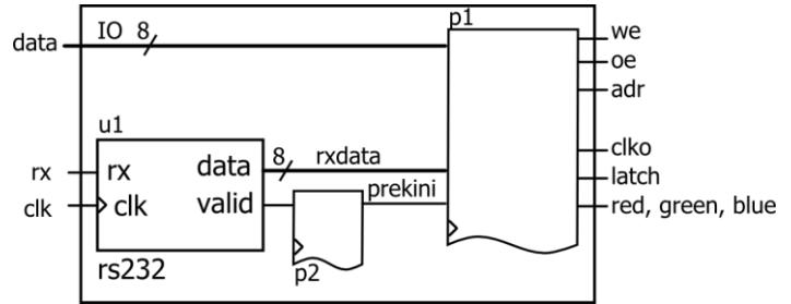
V vezju dodaj sinhroni proces za nastavljanje prekinitvenega signala. Signal prekini naj se postavi na '1' ob impulzu signala valid, in na '0' ko bo sekvenčni avtomat v stanju *vpis*. To naj bo novo stanje v obstoječem procesu, kjer bomo dodali logiko za vpisovanje sprejetega podatka v pomnilnik.
